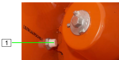
Abb. 24: Füllstandsonde im Materialbehälter
